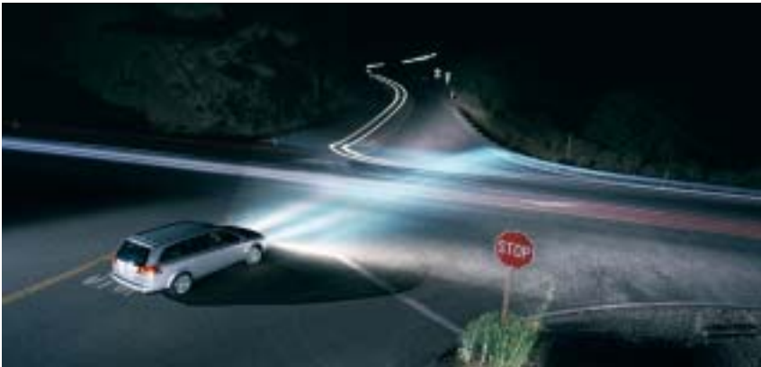
Das Bi-Xenon-Kurvenlicht AFL leuchtet bis zu 15 Grad in die Kurve (Opel Vectra und Opel Signum haben zusätzlich ein Kreuzungslicht)
