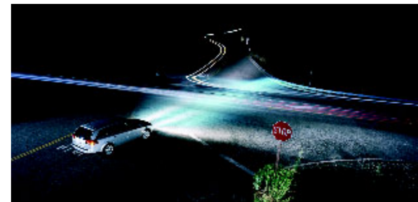
Das Bi-Xenon-Kurvenlicht AFL leuchtet bis zu 15 Grad in die Curve (Opel Vectra und Opel Signum haben zusätzlich ein Kreuzungslicht)
