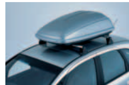
Travel Box, 350 l Fassungsvermögen, stabil, aber leichtgewichtiger, staub- und wasserdicht (139 x 90,5 x 42 cm). Lackierbar in Karosseriefarbe.
