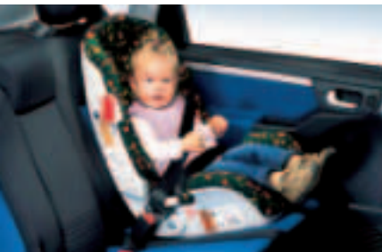
Kindersitz für den Transport von Kindern von 9 bis 25 kg. Nur auf dem Rücksitz zu verwenden. Für Kinder von 9 bis 18 kg in Verbindung mit einem separaten Sicherheitstisch verwenden.
