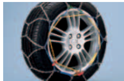
Schneeketten aus qualitativ hochwertigem Stahl, mit farbcodierten Teilen für die schnelle Montage.
