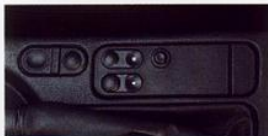
Elektrische Fensterheber. Öffnen und Schließen der Fenster mit Tippfunktion und Einklemmschutz.
