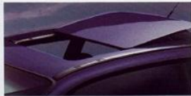
Elektrisches Schiebe- dach. Führt in Spoiler- stellung über die hintere Dachkante hinaus.
