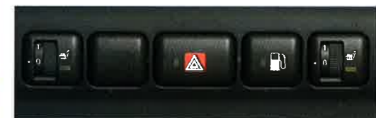
Das Antriebskonzept des Zafira 1.6 CNG heißt bei Opel monovalent plus . Geht der Gasvorrat zur Neige, können Sie das System einfach auf Benzinversorgung umschalten (2. Schalter von rechts)
