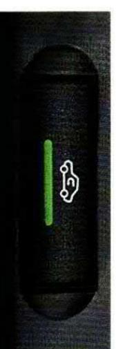
Serienmäßig in jedem Astra. Das Reinluft-Filter-System. Der Reinluft-Filter besteht aus einem Vorfilter, einem Feinfilter und einem Nachfilter. Die integrierte Umluftschaltung reduziert das Eindringen lästiger Gerüche wie beispielsweise Abgase.
