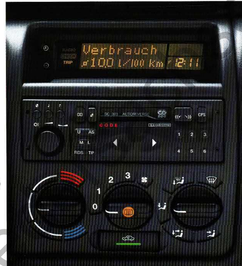
Die Informationszentrale im Astra GSi: das Multi-Info-Display. Neben Uhrzeit und Radiofunktionen, z. B. Senderfrequenzen, werden die Funktionen des Bordcomputers, wie Kraftstoffverbrauch, Durchschnittsgeschwindigkeit, Außentemperatur und Reichweite mit dem noch verfügbaren Kraftstoff, angezeigt. Serienmäßig im Astra GSi und auf Wunsch auch in anderen Astra-Modellen. (Radio SC 202 im Astra CD, Caravan CD und GSi 16V serienmäßig.)
