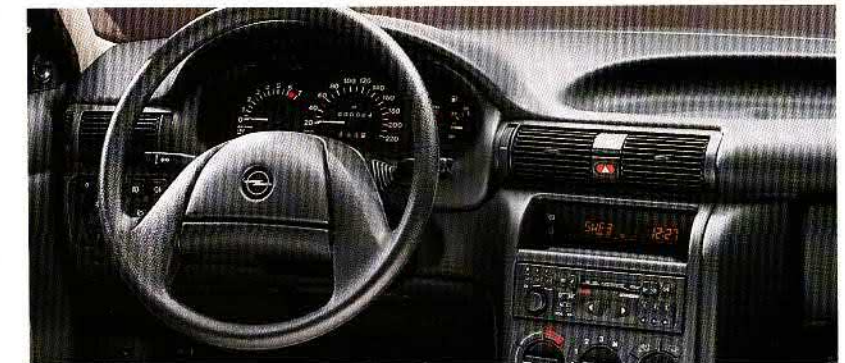
Das übersichtliche und ergonomische Cockpit des Astra GLS mit Instrumenten in Durchlichttechnik und Tankanzeige mit Literangabe. Die Servolenkung (serienmäßig ab Astra GLS und ab 1.6i-Motor in den anderen Modellen) sorgt für erhöhten Fahrkomfort.
