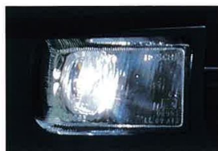
Nebelscheinwerfer in Stoßfänger integriert.
