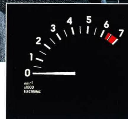
Instrumente inklusive Drehzahlmesser arbeiten mit Durchlichttechnik.
