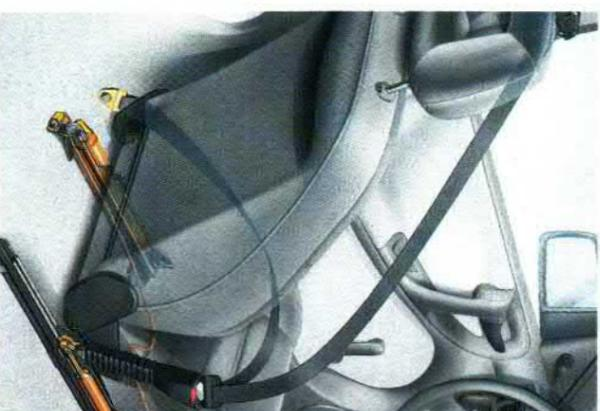
Das **Gurtschloß-ASTRA** straffer an den **Vordersitzen** reduzieren **im Fall eines Falls** die **Gefahr eines Kopf-aufpralls auf Lenkrad** oder **Instrumententafel** ganz **erheblich** (serienmäßig in allen Astra-Modellen).
