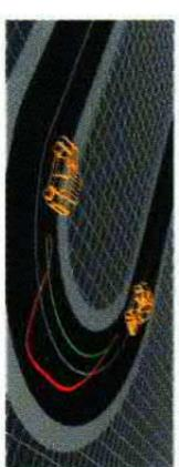
Elektronische Traction Control (ETC) sichert erhöhte Fahrstabilität bei unterschiedlich griffiger Fahrbahn, Eis, Schnee oder Regen. Es errechnet sensorgesteuert, wann und wie stark die Motorleistung reduziert werden muß, damit beide Antriebsräder wieder voll greifen.
