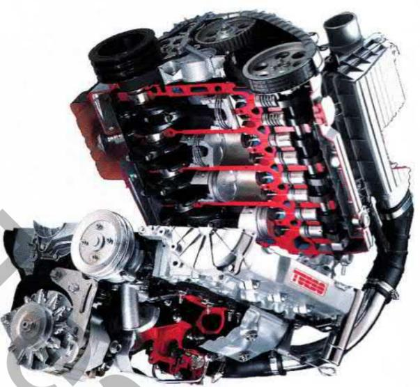
Der spritzige 1,7i-TurboDiesel mit 60 kW (82 PS). Turbodiesel und Ladeluftkühler (Intercooler) gehören zu seinen technischen Raffinessen.
