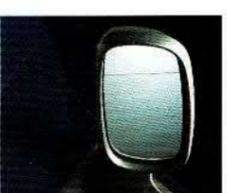
Alle Astra haben serienmäßig einen asphaltischen Außenspiegel auf der Fahrerseite. Er sorgt beim Überholen für sicheren Blick nach hinten.
