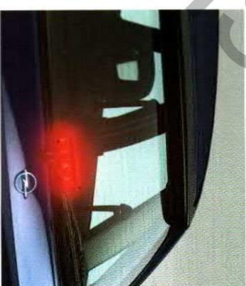
Zusatzbremsleuchte. Der Bremsvorgang wird selbst bei größerer Distanz früher wahrgenommen.
