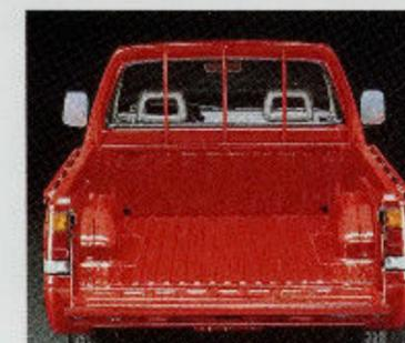
Egal, in welcher Version Sie ihn wählen: Jedes der neuen Opel Campo-Modelle läßt sich praktisch und sicher be- und entladen. Denn der Campo hat eine besonders niedrige und breite Ladekante. Sehr robust sind die Wände im Ladebereich: Sie sind aus doppeltem Stahlblech gefertigt.
