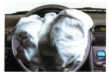
Im Bruchteil der Zeit, die ein Mensch für einen Augenaufschlag benötigt, öffnet sich der Airbag und ...
