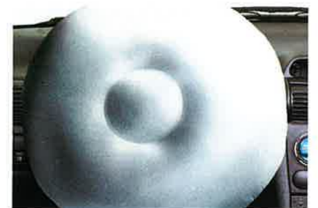
... ist etwa 40 bis 50 Millisekunden nach einem Frontalaufprall voll entfaltet.
