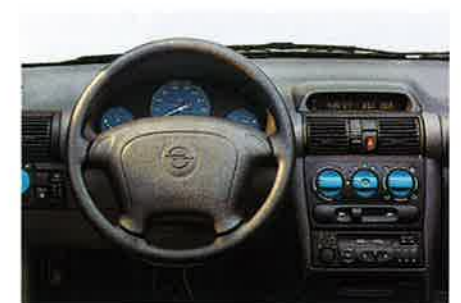
Auf der Fahrerseite befindet sich der Opel Full Size Airbag in dem speziellen Airbag-Lenkrad des Corsa.
