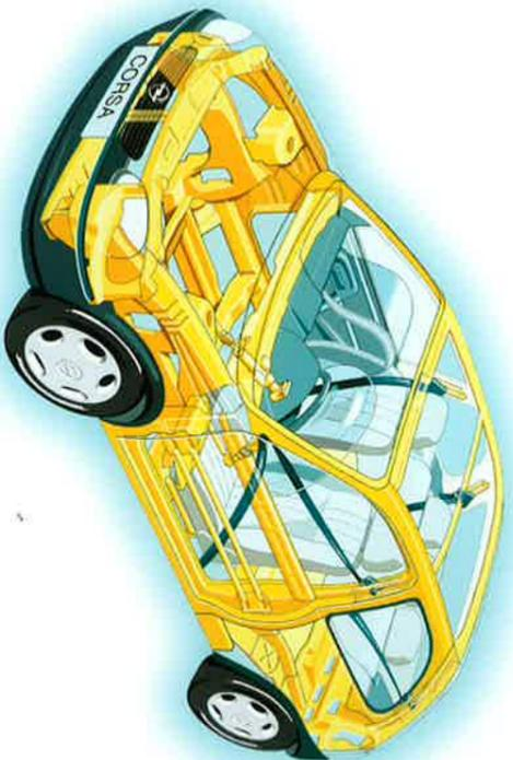
*Die Fahrgastzelle wurde nach vielen Computerberechnungen als Sicherheitskäfig mit verstärkten Seiten konstruiert.*
