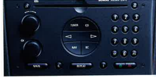
Siemens Stereo-CD-Radio NCDR 2011 mit integriertem Navigationssystem und monochromem Graphic Info Display, 4 x 20 Watt, 6 Lautsprecher u.v.m.
