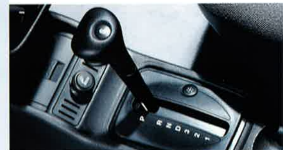
Wenn Sie's besonders bequem mögen: das Automatik-Getriebe mit 4 Fahrstufen und 3 Fahrprogrammen.
