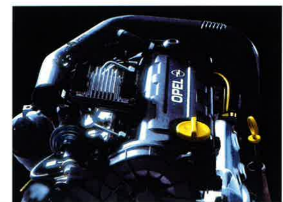
Überrascht durch seine eindrucksvolle Leistungsentfaltung und seinen geringen Verbrauch: der 1.7 DTI Turbodiesel-Motor mit Direkteinspritzung und 55 kW (75 PS).
