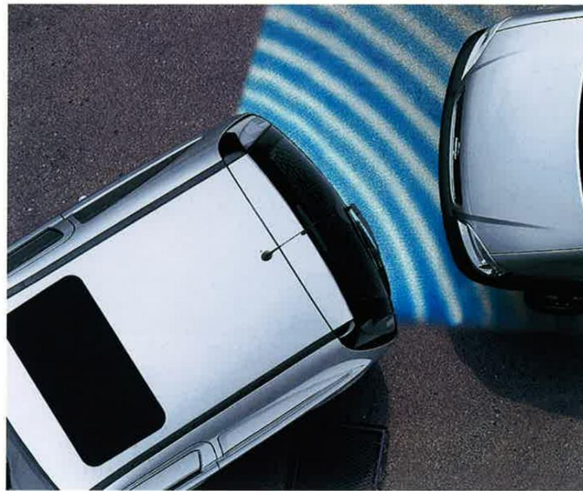
Opel Parksensoren warnen den Fahrer mit Ultraschallsensoren in der hinteren Stoßstange vor rückwärtigen Hindernissen. Schnelle Befestigung am Nummernschild durch einfachen Klick.
