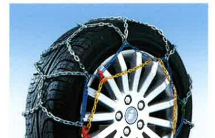
Schneeketten aus robustem Stahl mit Farbkodierung für eine einfache und schnelle Standmontage.
