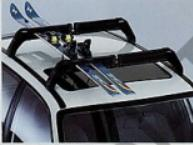
Skiträger. Mit dem Skiträger können Sie 6 Paar Ski vertikal bzw. horizontal transportieren. Erhältlich für Corsa, Astra, Vectra und Calibra.
