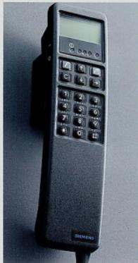
**Autotelefon.** Opel bietet zwei C-Note-Autotelefone anlegen, die Geräte Siemens C3 und C7/1. Beide Geräte einkaufen sich neben der geringen Baugröße besonders durch eine digitale Frequenzschaltung mit in die Karteleserleinheit integrierten Frequenzsynthesis aus, d.h.: Man kann gleichzeitig hören und sprechen und hat die Hälfte frei zur Bedienung des Fahrzeugs. Natürlich
