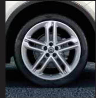
Leichtmetallrad 7½ J x 19 im „5-Doppelspeichen“-Design, Sterling Silber, Reifen 225/45 R 19 (RT7), Option für Edition, Color Edition, INNOVATION und Color INNOVATION.
