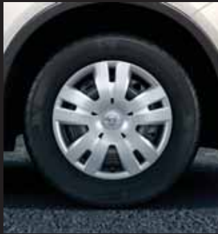
Stahlrad 6½ J x 16 inkl. Abdeckung, Reifen 215/65 R 16 (RRY), Serie für Selection.
