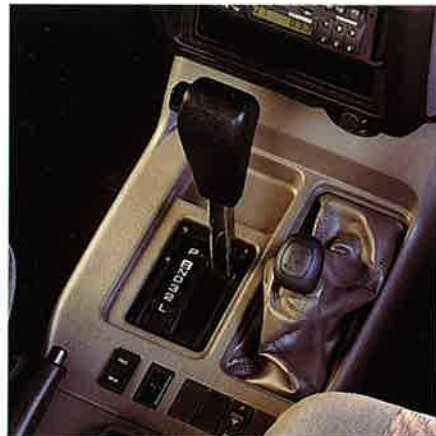
Nur für 3.2-V6-24V: ein 4-Gang-Automatik- getriebe mit Allradantrieb
