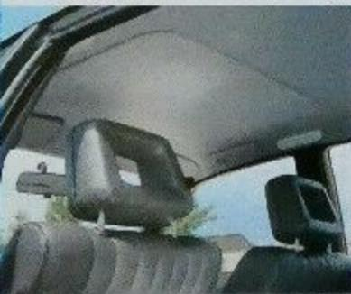
Oben: Der Omega Caravan, ausgestattet als kommunales Dienstfahrzeug mit Lackierung RAL 2011, orange (schwermetallfrei). Links unten: Eine integrierte Deckenverkleidung gewährleistet Zutritt zu den elektrischen Anschlüssen der Dachaufbauten.
