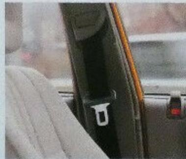
Rechts unten: Ein Plus an Sicherheit für die Insassen; die Sicherheitsgurte im Omega sind vorne und hinten höhenverstellbar und passen sich unterschiedlichen Körpergrößen perfekt an. Links: Anatomisch geformte Vollschaumsitze, vielfach einstellbar für optimale Sitzposition.
