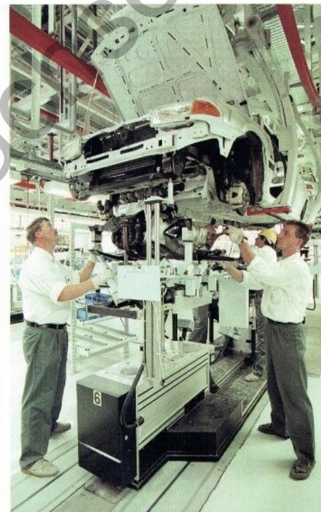
**Hochzeit:** Der Zusammenbau von Chassis und Karosserie – die sogenannte Hochzeit – ist der Höhepunkt der Fahrzeugmontage.
