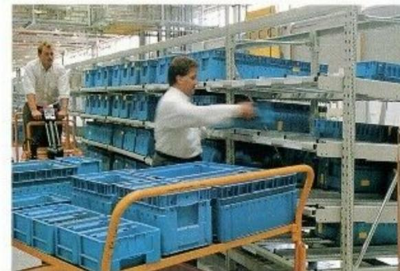
**Depot:** Die Automobilteile sind in kleinen, überschaubaren Behältern verpackt, die sich griffgünstig neben den Arbeitsstationen plazieren lassen.
