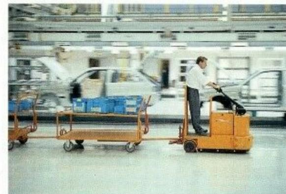
**Lieferung:** Die Materialversorgung der Arbeitsstationen erfolgt mit Hilfe spezieller Transportfahrzeuge.
