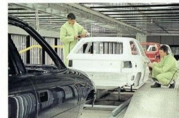
**Spritzkabine:** Elektrostatische Rotationszerstäuber garantieren eine gleichmäßige Verteilung der wasserverdünnten Lacke auf dem Karosserieblech.
