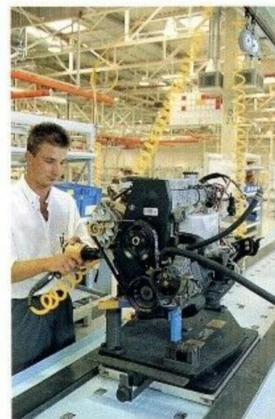
**Motorenmontage:** Die Komplettierung der Motoren erfolgt abseits der Montagelinie.
