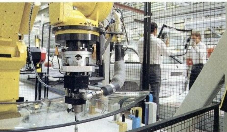
**Automation:** Ein Roboter übernimmt das millimetergenaue Auftragen des Scheibenklebers.
