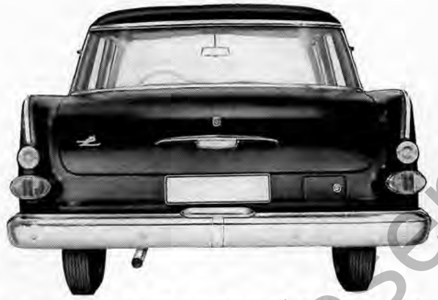
DAS HECK des Kapitän „L“. Das flache, schwach gewölbte Dach läuft über der vergrößerten Rückwand-Panoramasscheibe aus. Der großvolumige Kofferraum ist unter dem flachen, fast bis zur Wagenseitenlinie reichenden Deckel leicht und bequem „beschildbar“. Die ovale, waagrecht angeordnete Brems-Schluß-Blinkleuchten-Kombination, deren rechteckiges Mittelstück von einem Rückstrahler gebildet wird, wurde weit nach unten und außen gesetzt
