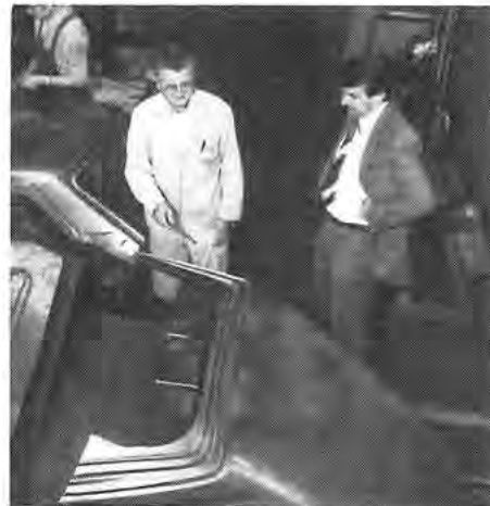
Fachdiskussion am Ziehteil Dach. Im Gespräch Obermeister Franz Pluschke (links) mit Betriebsleiter Leopold Lachnik. Im Hintergrund Mitarbeiter Günter Ciupek, der Luftlöcher in einen Stempel Dachwerkzeug bohrt.
