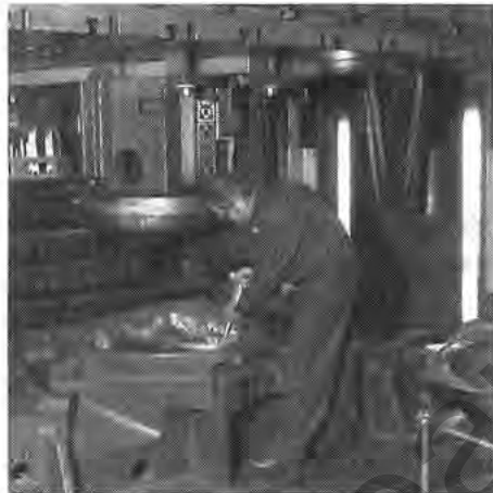
Eintuchieren (einschleifen) einer Ziehmatrize für ein Radgehäuse mit dem bereits fertiggestellten Ziehstempel. Mitarbeiter Heinz Decker wurde bei dieser Arbeit aufgenommen.
