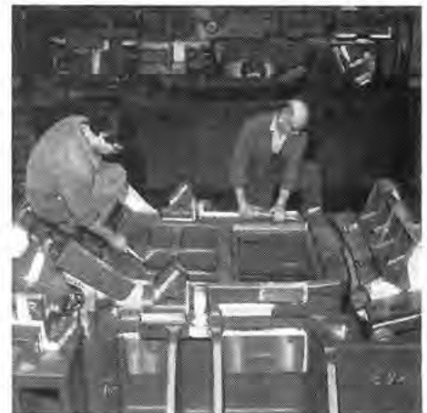
An einem Dachwerkzeug (Tuchierpresse) werden Tuchierarbeiten (Einschleifarbeiten) vorgenommen. Von links Mitarbeiter Klaus Kuntze und Gerhard Lummitsch.
