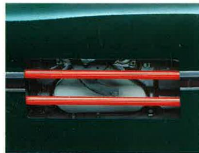
Integrierte Doppel-Stahlrohrverstärkungen in den Seitentüren.
