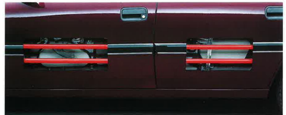
Die integrierte Doppel-Stahlrohrverstärkung in den
