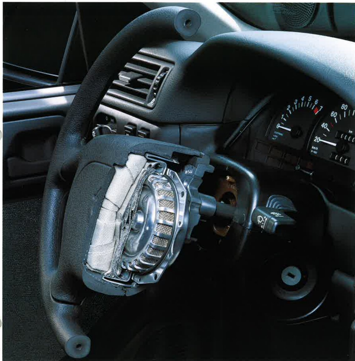
Der zusammengefaltete Airbag im Pralltopf des Lenkrads.
