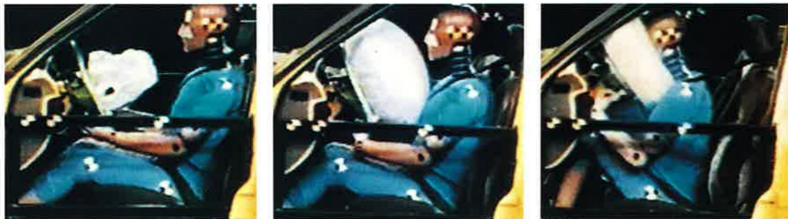
Computersimulation leistet wertvolle Hilfe dabei, den Opel Full Size Airbag optimal an das spezifische Crashverhalten des neuen Vectra V6 anzupassen.
