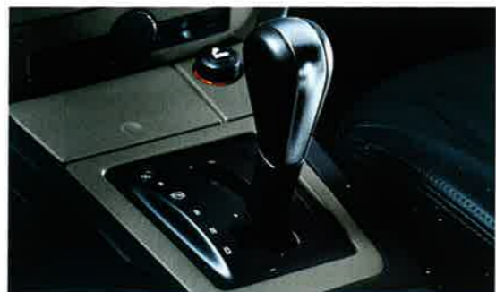
Anpassung der Getriebecharakteristik: Mit dem vollständig neuen 5-Gang-Automatikgetriebe mit ActiveSelect ® -Funktion hat der Fahrer die Wahl zwischen einem adaptiven Automatikprogramm, das sich dem individuellen Fahrstil anpasst, und einer sportlicheren Gangart, bei der die Gänge durch manuelles Antippen des Schalthebels gewechselt werden.
