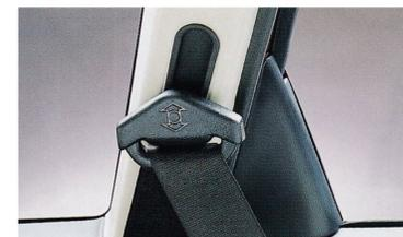
Höhenstellbare Sicherheitsgurte vorn und hinten für optimalen sicheren und bequemen Sitz, unabhängig von der Körpergröße.
