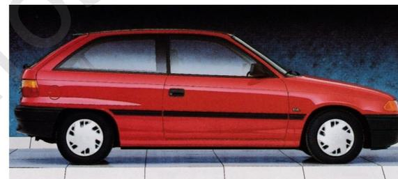
Die bis zum Stoßfänger heruntergezogene Heckklappe sorgt für eine niedrige Ladekante und bequemes Be- und Entladen.
