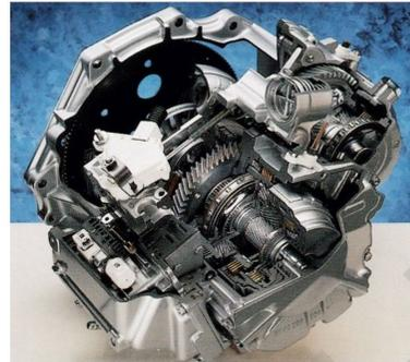
Für den Astra gibt es auch eine neue, kompakte 4-Stufen-Automatic mit elektronischer Steuerung, die geringen Verbrauch mit erhöhter Schaltqualität verbindet. Das Getriebe ist beim Starten automatisch im Economy-Fahrprogramm. Sport- oder Winterfahrprogramm kann vom Fahrer durch einfachen Knopfdruck angewählt werden.
