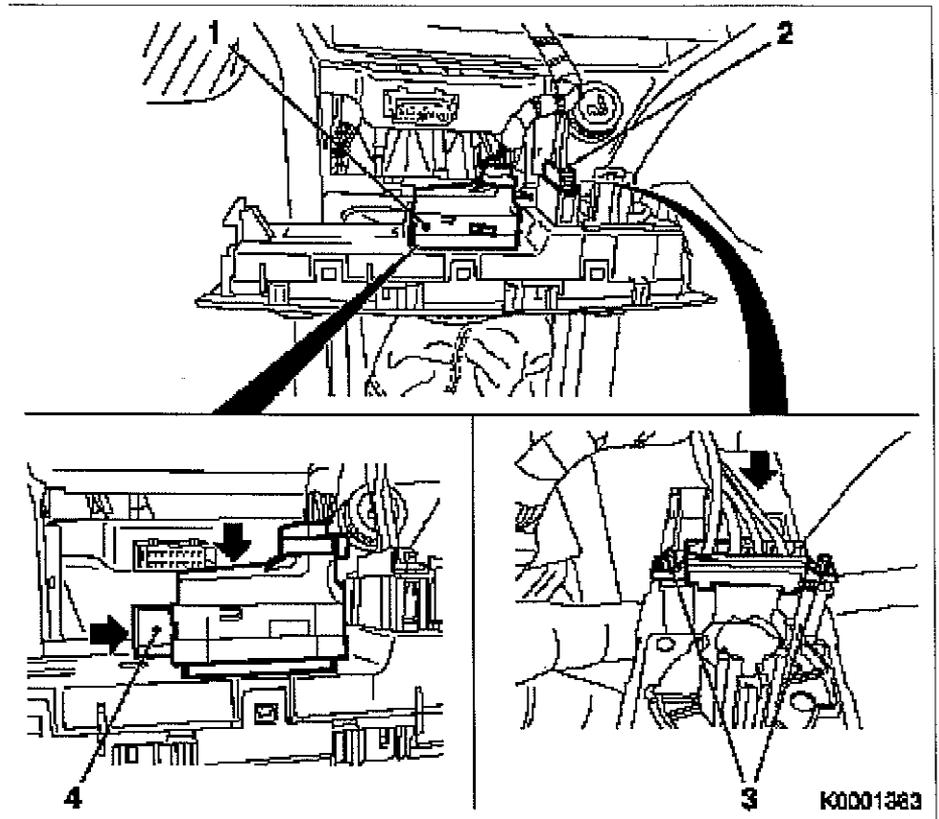
6. Bediengerät Heizung/Klimaanlage einbauen
