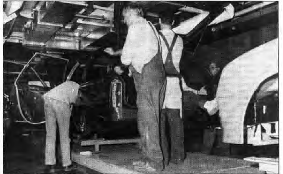
Mittfahrer: Die modernen Paletten bieten ausreichend Platz für eine sichere Montage
