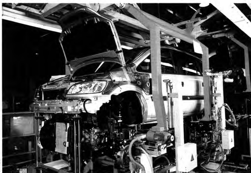
In Treue fest: Am laufenden Band werden Karosserie und Chassis automatisch verbunden
