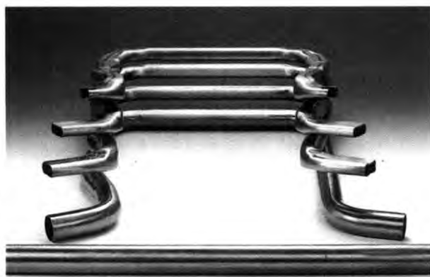
Wasser marsch: Vorderachsträger durch Hydroforming
