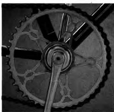
Wie neu: Das Kettenblatt mit den fünf „O“ für Opel sowie andere Details wurden vorbildlich restauriert
