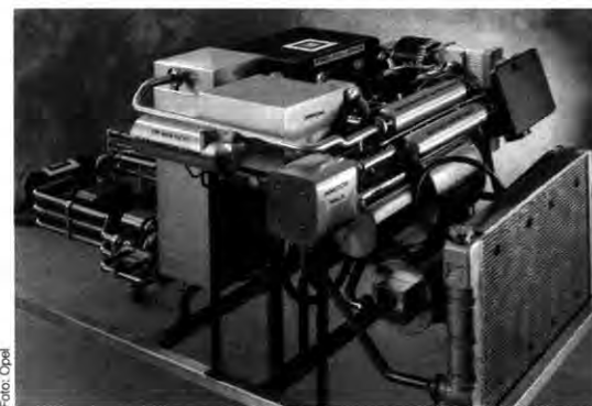
Reformer: Aus Benzin wird Wasserstoff erzeugt
