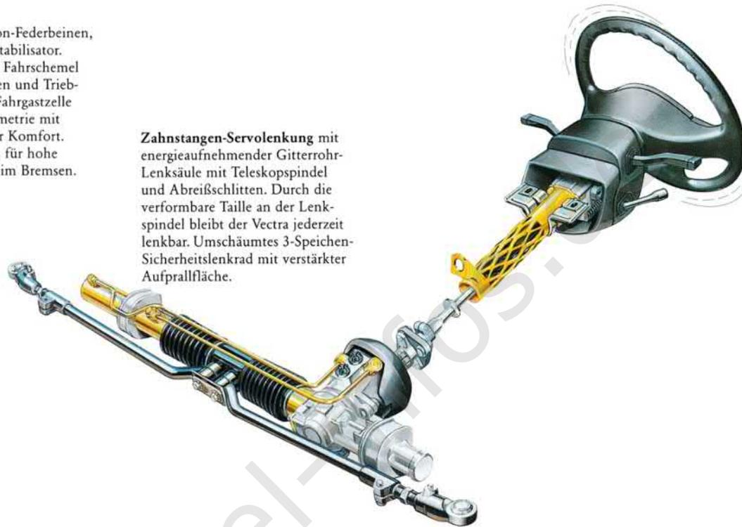
**Zahnstangen-Servolenkung** mit energieaufnehmender Gitterrohr-Lenksäule mit Teleskopspindel und Abreißschlitten. Durch die verformbare Taille an der Lenkspindel bleibt der Vectra jederzeit lenkbar. Umschäumtes 3-Speichen-Sicherheitslenkrad mit verstärkter Aufprallfläche.
