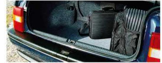
530-l-Kofferraum (VDA/brutto) mit niedriger Ladekante für bequemes Be- und Entladen. Warndreieck und Verbandkasten sind in einem speziellen Fach im Kofferraum gut untergebracht.
