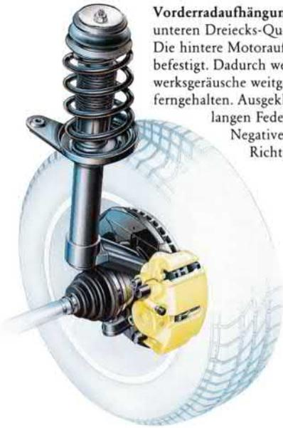
**Vorderradaufhängung** mit McPherson-Federbeinen, unteren Dreiecks-Querlenkern und Stabilisator. Die hintere Motoraufhängung ist am Fahrschemel befestigt. Dadurch werden Vibrationen und Triebwerksgeräusche weitgehend von der Fahrgastzelle ferngehalten. Ausgeklügelte Achsgeometrie mit langen Federwegen für mehr Komfort. Negativer Lenkrollradius für hohe Richtungsstabilität beim Bremsen.
