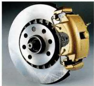
**Diagonales Zweikreisbremssystem** mit Bremskraftverstärker und Bremskraftregler. Bei 1.6i-, 1.8i- und 1.7-TD-Motoren Scheibenbremsen vorn und Trommelbremsen hinten; beim 2.0i-Motor Scheibenbremsen vorn und hinten (vorn innenbelüftet). Asbestfreie Bremsbeläge.
