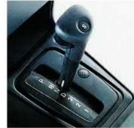
Vollelektronisch gesteuerte 4-Stufen-Automatic mit drei verschiedenen Fahrprogrammen. Per Knopfdruck wird die Sport-Übersetzung aktiviert. Diese schaltet bei Erreichen der Nenn-drehzahl in den nächsthöheren und entsprechend frühzeitig in den nächstkleineren Gang. Ein feinfühlig gesteuertes Winter-Programm sorgt dafür, daß Ihr Vectra auf glatten Straßen samtweich anfährt.
