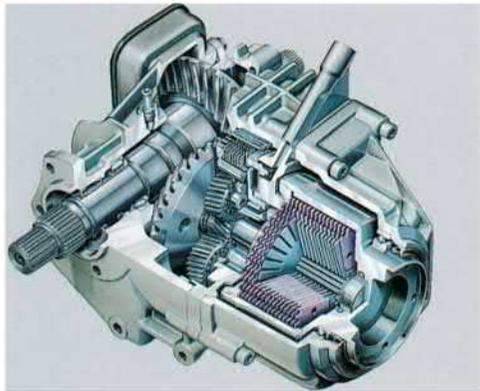
Die vollautomatische Abschaltung erfolgt durch eine hydraulische Lamellen-Trennkupplung, die ins Verteilergetriebe integriert ist. Eine weitere Besonderheit dieses Getriebes ist die Viskose-Kupplung, die selbständig das Antriebsmoment zur Hinterachse regelt, je nach Straßenzustand und Beladung des Fahrzeugs.
