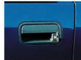
Zentralverriegelung mit Diebstahlsicherung. Im Handumdrehen sind alle vier Türen, der Kofferraum und sogar der Tankdeckel verschlossen. Eine neue Ultraschall-Diebstahlwarnanlage besteht aus mehreren Sensoren, mit denen Türen, Kofferraumdeckel, Motorhaube, Radio und Innenraum bestückt sind. Ist das System aktiviert und wird dann versucht, das Fahrzeug zu öffnen oder in den Innenraum einzudringen, werden Hup- oder Lichtsignale ausgelöst. Außerdem läßt sich das Fahrzeug dann nicht starten.
