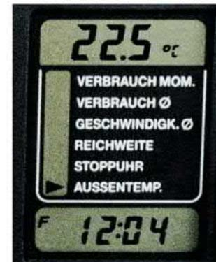
Der Bordcomputer gibt Ihnen auf Knopfdruck den momentanen Verbrauch, den durchschnittlichen Verbrauch seit Antritt der Fahrt, die Durchschnittsgeschwindigkeit und die Reichweite bei momentanem Kraftstoffvorrat an. Außerdem besitzt er eine Stoppuhr-Funktion und zeigt die Außentemperatur an.
